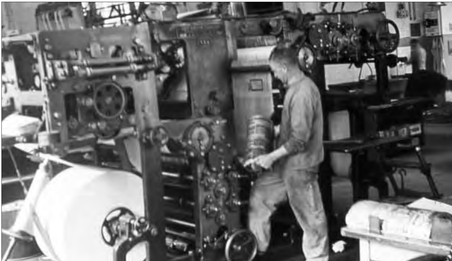
«Viel zu reden, viel zu schreiben, viel zu drucken»: Rotationsdruckmaschine der Druckerei Lüdin AG, Liestal, 1944
