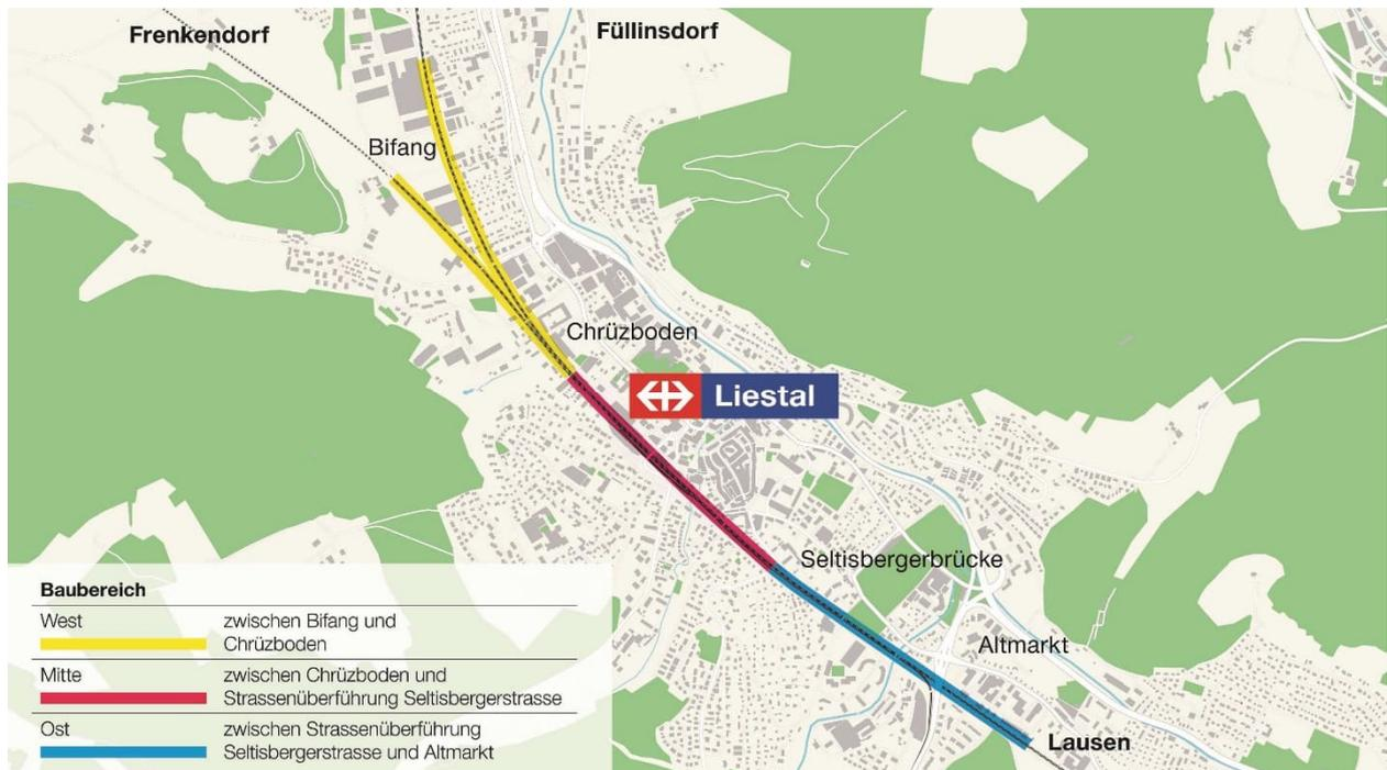
Der Projektperimeter für den Vierspurausbau erstreckt sich von der Frenkenbrücke bis zum Portal des Adlertunnels und zur Schauenburgerstrasse. Der Projektperimeter für das Wendegleis und das Projekt Bahnhofareal beschränkt sich auf die Bahnhofnordseite. Damit Sie die unten aufgeführten Arbeiten besser verorten können, haben wir den Perimeter in die drei Bereiche «West», «Mitte» und «Ost» unterteilt.
