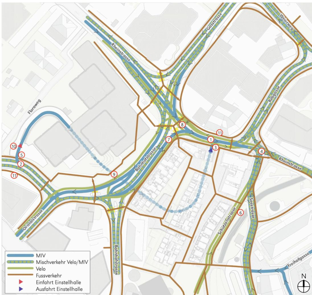
Abbildung 14: Spurlinienplan Variante 4
