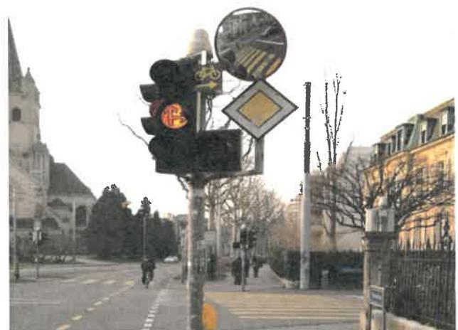
Das Signal besteht aus einem quadratischen Blech, das ein gelbes Fahrradpiktogramm sowie einen Richtungspfeil nach rechts beinhaltet (Abbildung 2, S. 2).
