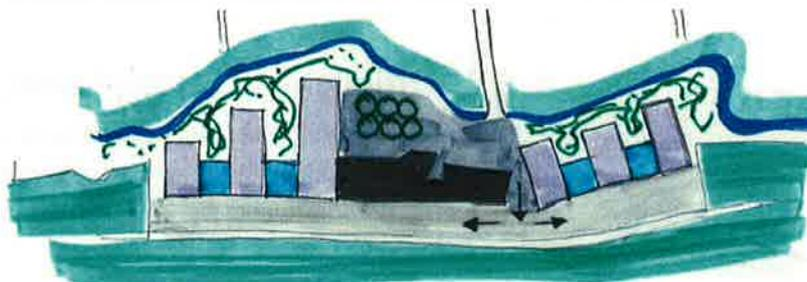
Im vorgeschlagenen Baukonzept werden die beiden bestehenden Gebäude in der Mitte des Areals seitlich durch Neubaukomplexe erweitert: Sie umfassen je einen 2-geschossigen Längsbau und 4 -5-geschossigen Querbauten. Dieses Konzept ermöglicht eine grosse Bebauungsdichte von ca. 19600qm BGF.
