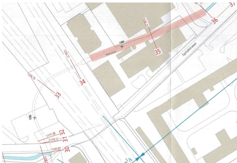
Abbildung 2 Abschnitt überlasteter Querschnitt Rösernbach (Quelle: Bericht Abflusskapazität Rösernbach Situationsanalyse, Sutter Ingenieur- und Planungsbüro)
