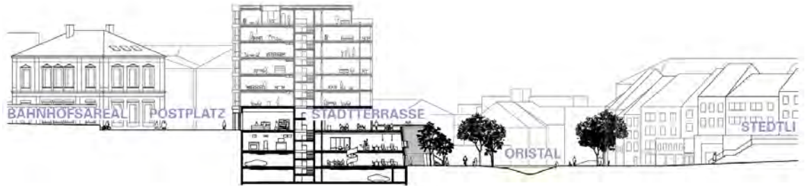
Abbildung 14: Querschnitt mit den verschiedenen Ebenen zwischen Bahnhof und Altstadt (Christ+Gantenbein)
