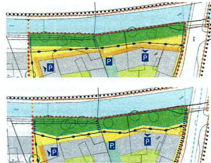
Abb. 12: Gegenüberstellung Uferschutzzone alt (oben) neu (unten)
